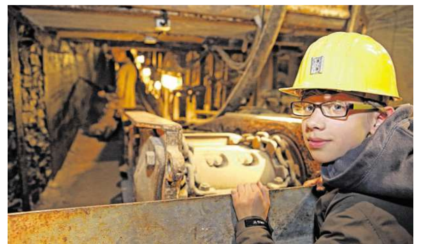
Blick in den Streb: Mit dem Panzerförderband wurde die herausgeschlagene Kohle aus dem Stollen transportiert.
